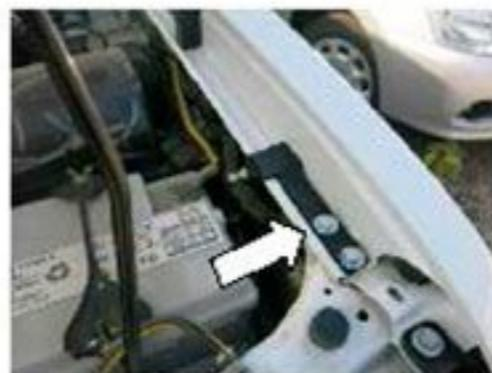
2. Установить кронштейн крыла, как показано на рисунке. Плотнo прижать подгиб кронштейна к кузову и затянуть болты ключом №10 с усилием 9 Нм.
